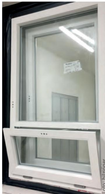
*Das Prinzip von MaturaCity (hier auf dem Prüfstand): Der große Außenflügel befindet sich in Kippstellung und der kleine Kippflügel im Innenflügel („Flügel im Flügel“) ebenfalls. In dieser Lüftungsstellung ist noch immer ein Schalldämm-Maß von 32 dB gegeben, also ein Wert, den sonst ein Standardfenster im geschlossenen Zustand erreicht.*
