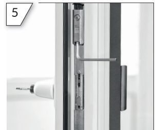
Einstellung der Höhe über den Türschnäpper (nur bei Fenstertüren). (SW4)
