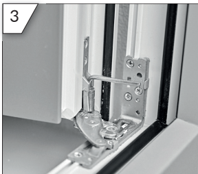
3 Höheneinstellung des Fensters über das Ecklager. (SW 4)
