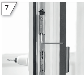
7 Einstellung der Höhe über den Türschnapper (nur bei Fenstertüren). (SW4)
