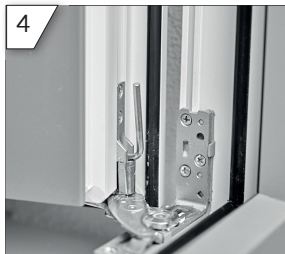
4 Seiteneinstellung des Fensters über das Ecklager. (SW 4)
