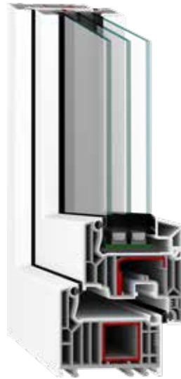
Standardrahmen 3) in schlanker 73 mm Ansichtsbreite. Optional gibt es das Rahmenprofil auch in 83 mm Ansichtsbreite.
