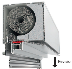
Revision raumseitig unten Die innere, untere Blende kann zur Revision geöffnet werden.
