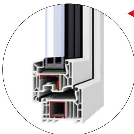
◀ Optional gibt es auch Supertherm 82 AD mit zwei umlaufenden Dichtungsebenen und einem Uf-Wert bis 1,2 W/m<sup>2</sup> K.
