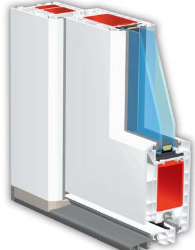
Haustürprofil Modell hilzinger Prestige, System Anschlagdichtung, flächenversetzt mit abgerundeten Konturen und thermisch getrennter Schwelle.
