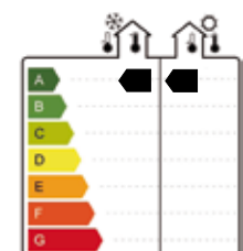
Effizienzklasse für winterlichen Wärmeschutz (links) und sommerlichen Wärmeschutz (rechts) für Zenit 76. 4)
